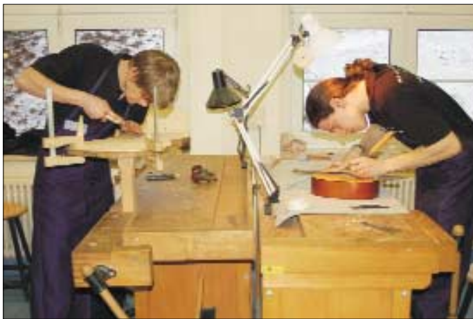
Die beiden Zupfinstrumentenbauer Florian und Martin zeigen den Gästen das Fertigen von Gitarrenböden.
