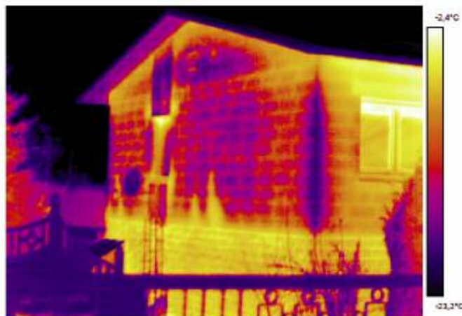
Vor der Dämmung
