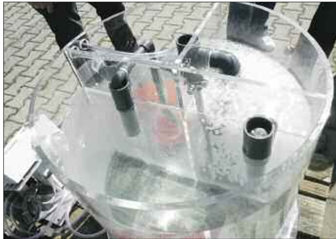
Modell einer biologischen Kleinkläranlage, die im Wirbel-Schwebbett-Verfahren arbeitet. Foto: ZWAV
