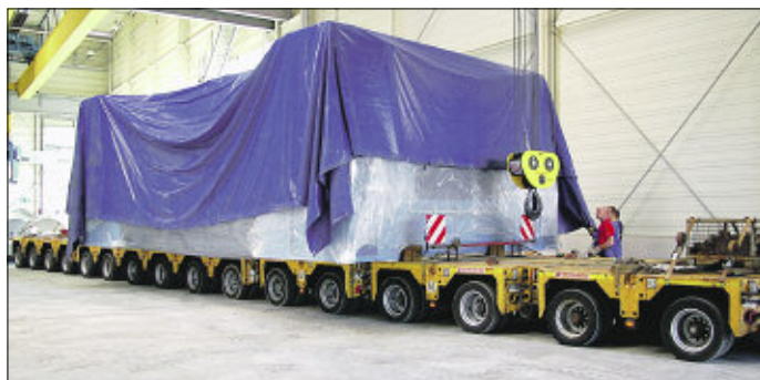
Nur mit ganz großer Technik ließ sich der 156 Tonnen schwere Pressentisch Zentimeter um Zentimeter bewegen. Fotos: Dieter Krug
