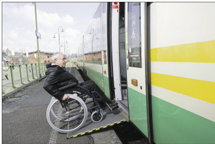
Niveaufreies Einsteigen und Aussteigen mit einer Rampe am Bahnhof Weischlitz Foto: VVV
