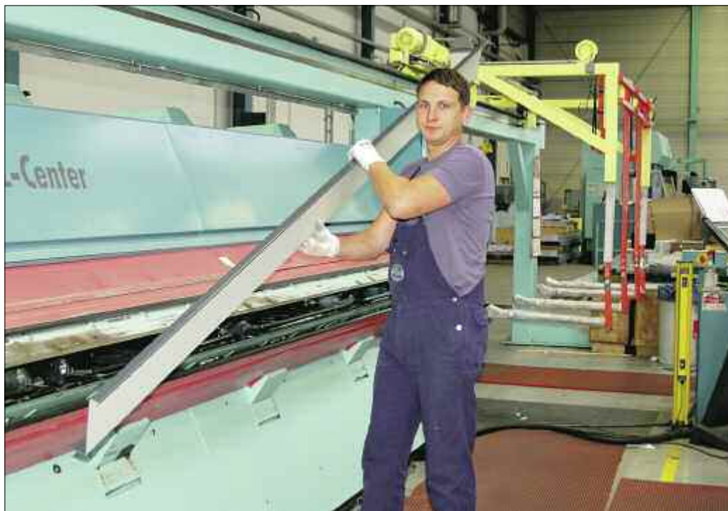
Pressenbediener Florian Fanghänel beim Bearbeiten von so genannten Tropfkanten, die an Gebäuden, die Goldbeck baut Verwendung finden. Foto: Dieter Krug
