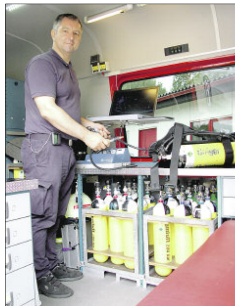
Atemschutzgerätewart Frank Rössel zeigt die Überprüfung eines Pressluftatmers im Fahrzeug, wie sie vor Ort vorgenommen wird.
